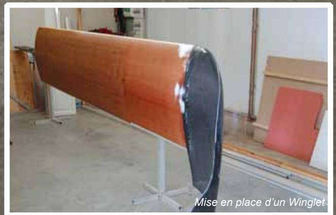
*Mise en place d'un Winglet*
