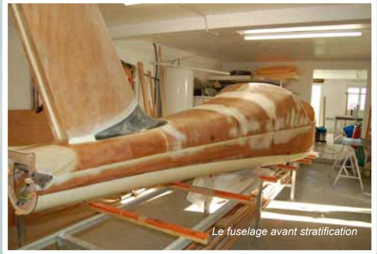
*Le fuselage avant stratification*
