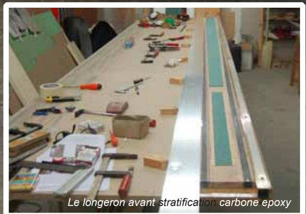
Le longeron avant stratification carbone epoxy
