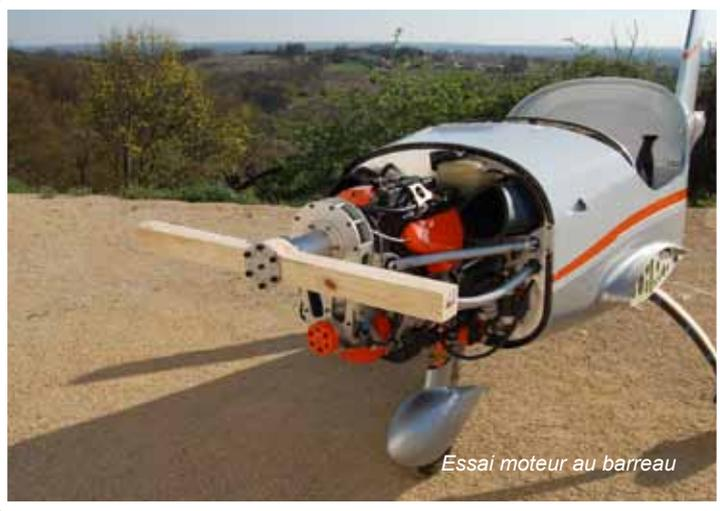
*Essai moteur au barreau*
