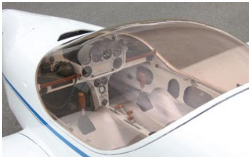
Les palonniers actionnent la commande de direction par des câbles. La dimension de la roue avant est de 350/4 sur l'avion et 400/4 sur l'ULM.
